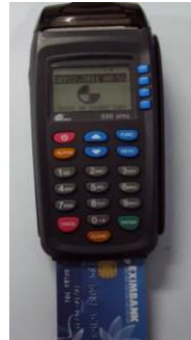
Thiết bị đọc thẻ không dây: mặt băng từ hướng vào trong
